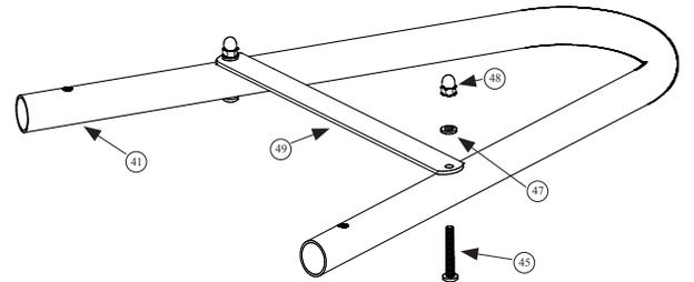
Les vis de mécanique (45) doivent être installées de l'intérieur de la Poignée (41), vers l'extérieur, à travers l'Entretoise de la Poignée avec l'Étiquette de Sécurité (49) à l'extérieur. Assurez-vous que l'étiquette de sécurité en français apparait à l'extérieur des deux poignées. Posez la Rondelle Frein (47) et vissez l'Écrou Borgne (48) jusqu'à serrer solidement l'entretoise contre la Poignée.
